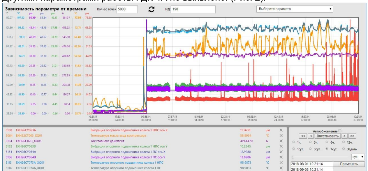
Рис. 2 Вибрационное состояние опорного под-ка колеса 1 ГДК-1А.
