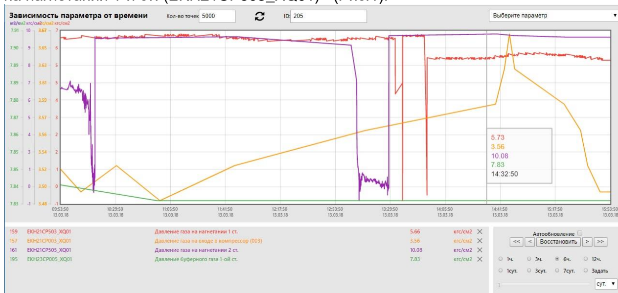
Рис.1 Давление газа на нагнетании 1 ст. компрессора
